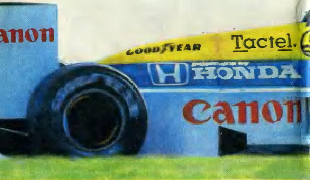
чивающие хорошее сцепление с дорогой, но недолговечные, и «твердые», более износостойкие, но на них сложнее вписаться в повороты. И от верного выбора резины подчас зависит успех команды.
